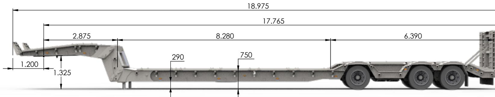
PARA QUEDAR DENTRO DE LOS 22,4 m PERMITIDOS EN ESTA CONFIGURACIÓN, EL CAMIÓN DEBE TENER MENOS DE 4,635 m ENTRE EL FRENTE Y EL PERNO REY
