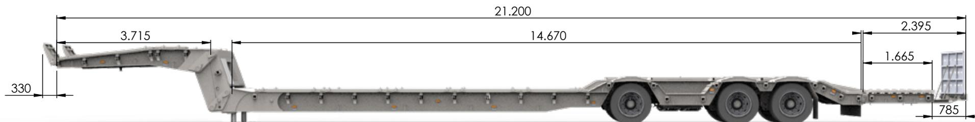
LARGO MÁXIMO PERMITIDO EN ESTA CONFIGURACIÓN, CON CAMIÓN: 25 m
